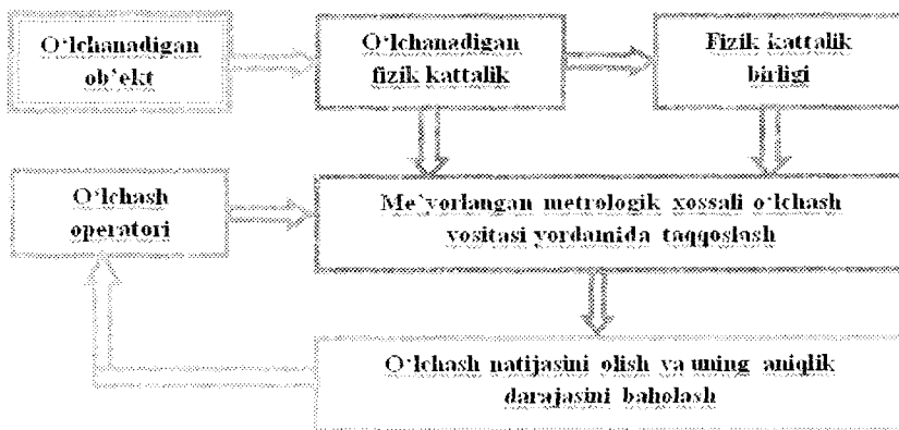
3.1-rasm. Fizik kattalikni o'lchash jaroyoni sxemasi
