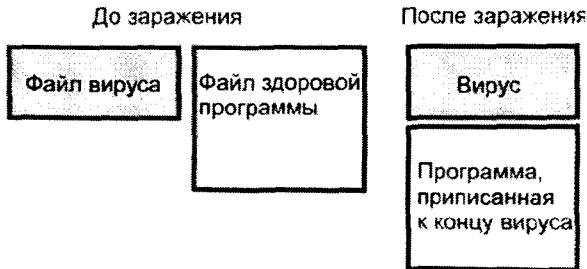
Рис. 3.2 ❖ Принцип заражения, используемый «оверлейными» вирусами
