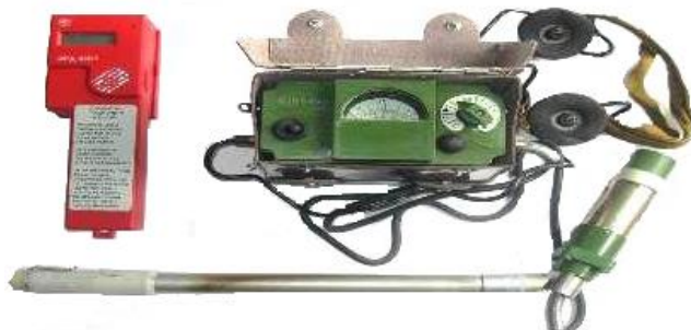
33 - rasm. Rentgenometr ДП-58 (А) va dozimetr ИПД-02Б16 larning (Б) umumiy ko'rinishi.
