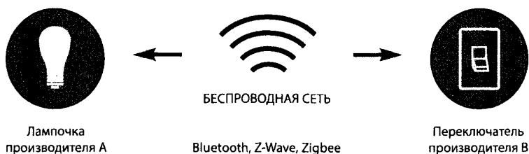
Рис. 3.4. Пример модели подключения от устройства к устройству
