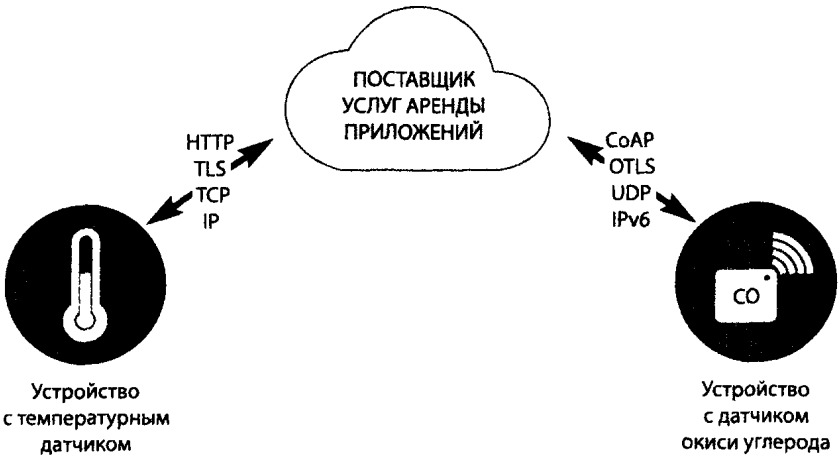
Рис. 3.5. Пример модели подключения от устройства к облаку
