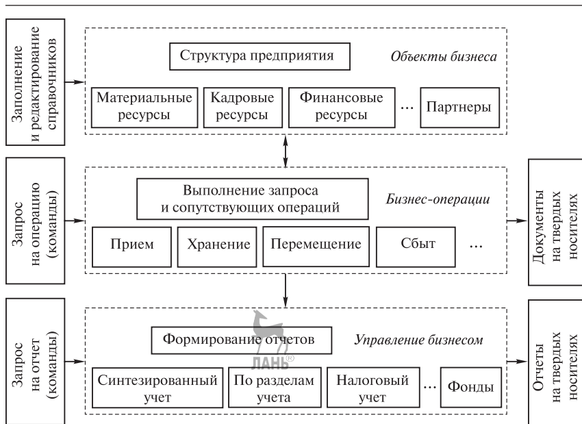
Рис. 3.5. Организация информационных процессов в модульной информационно-технологической системе
