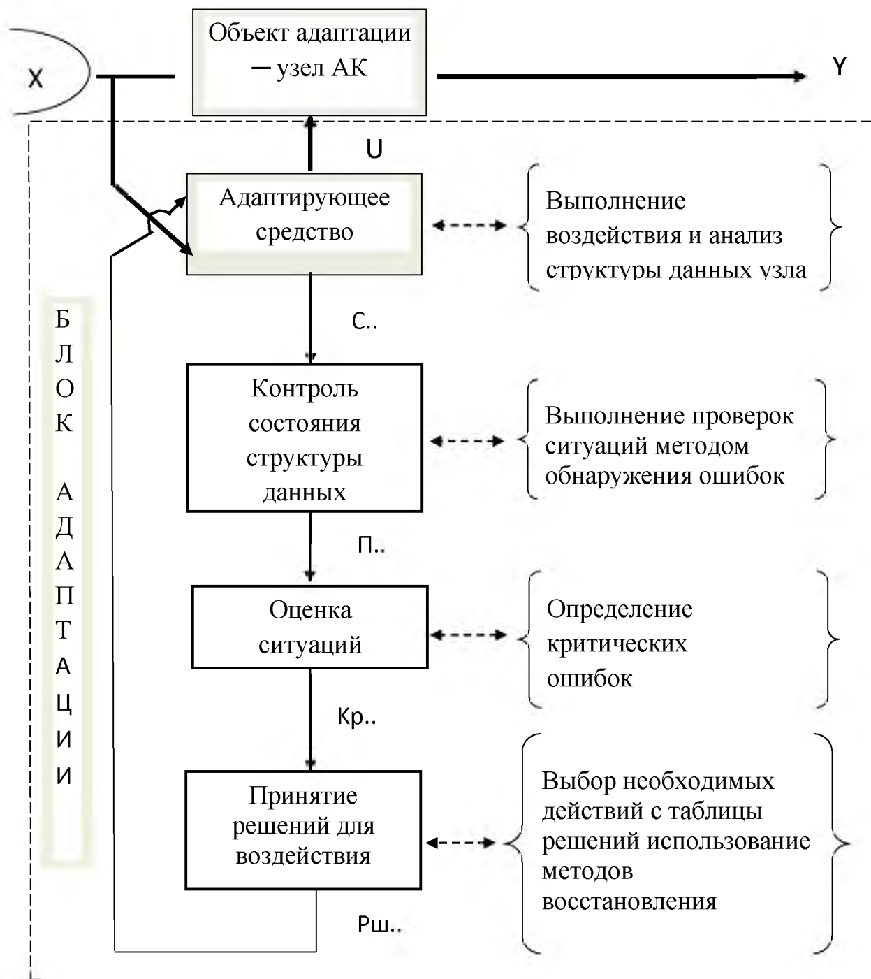
Рис. 2.4. Схема работы модели адаптации структур данных узла адаптивной коммутации
