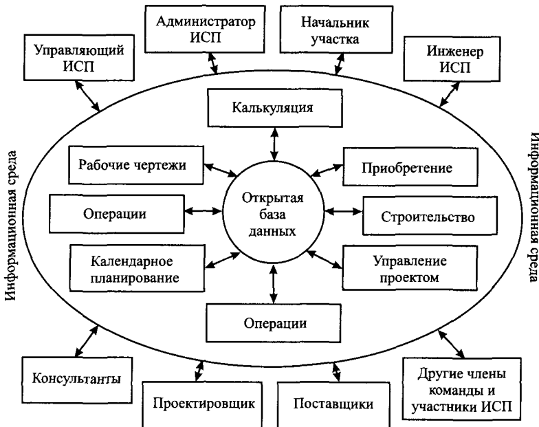
Рис. 10.3. Модель системы комплексно-автоматизированного строительства для ИСП
