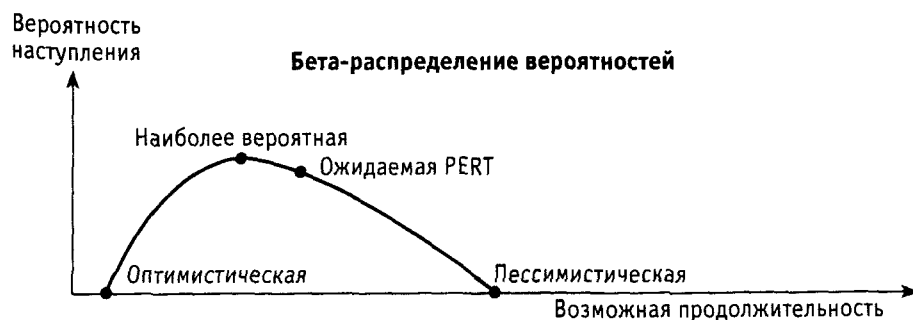
Рисунок 13.3. Схема оценок в PERT
