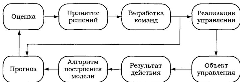
**Рис. 11.3.** Функциональная схема системы управления с акцептором действия
