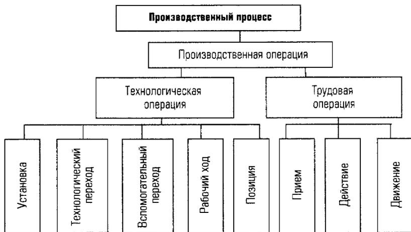
**Рис. 13.** Состав производственной операции в технологическом и трудовом отношениях
