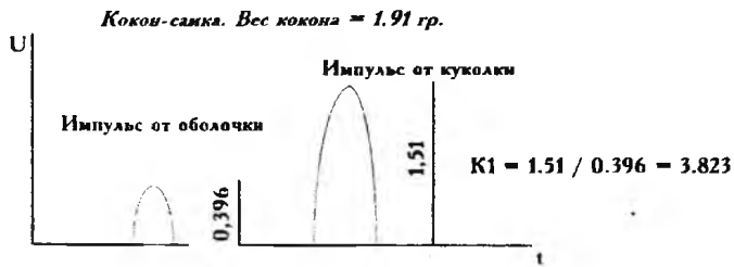
Рис. 1 Картина взаимодействия оболочки кокона и куколки с пьезоэлементом
