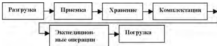
Рисунок 3.10 — Пример принципиальной схемы технологического процесса на складе предприятия оптовой торговли
