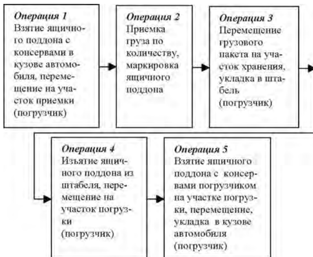
Рисунок 3.14 — Пример пооперационной схемы технологического процесса на складе (консервы транспортируются в ящиках, хранятся на плоских поддонах)
