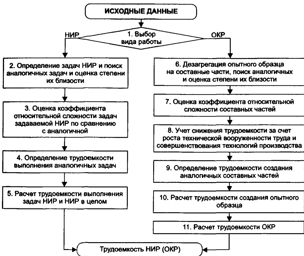
Рис. 3.3. Блок-схема алгоритма методики оценки трудоемкости НИР (ОКР) на основе данных о технических решениях, использованных в аналогичных разработках
