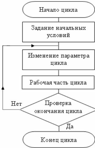
Рис. 5. Типовая схема циклического алгоритма с постусловием
