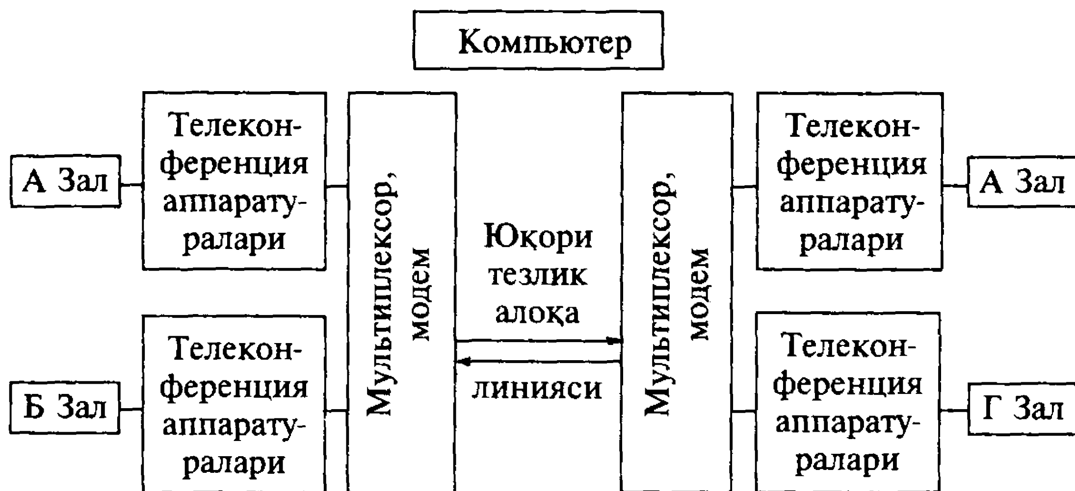
1.33-р а с м. Телеконференцияни ташкил этиш схемаси.
