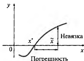
Рис. 10.5. Взаимосвязь невязки и погрешности
