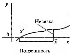
Рис. 10.6. Малая невязка и большая погрешность
