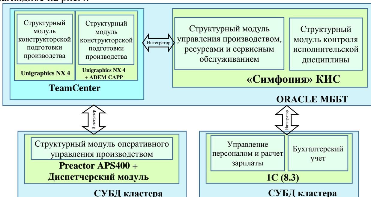
Рис. 4. Структурная схема комплексной информационной системы ООО «Завод по переработке Мубарекского газа»<sup>15</sup>
