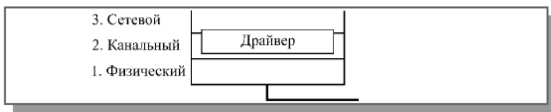
Рис.9.1. Функции драйвера сетевого адаптера в модели OSI
