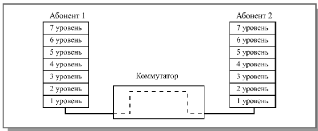
Рис.6.6 Функции коммутаторов в модели OSI
