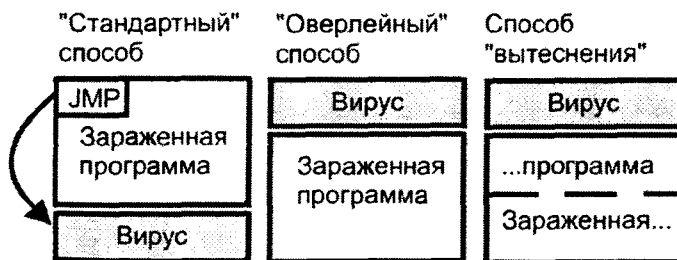
Рис. 3.3 ❖ Основные способы заражения COM-программ
