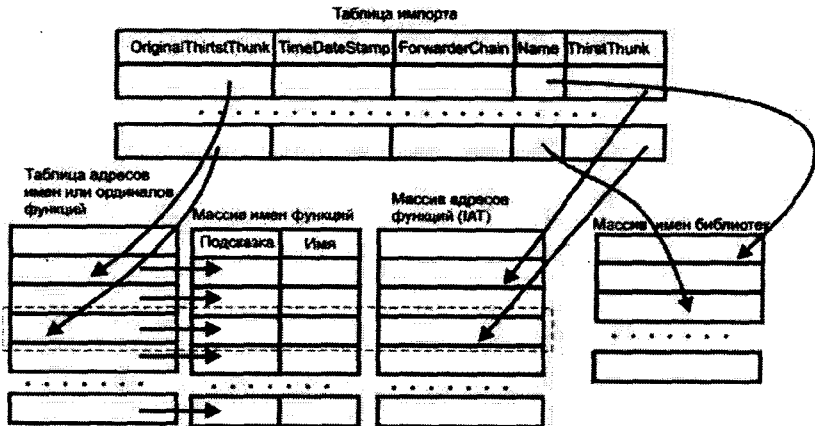
Рис. 4.11 ❖ Организация импорта в PE-программах
