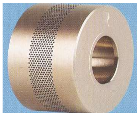
185-расм Чизиқий зичлиги паст компакт ип қурилмасининг перфовалиги.
