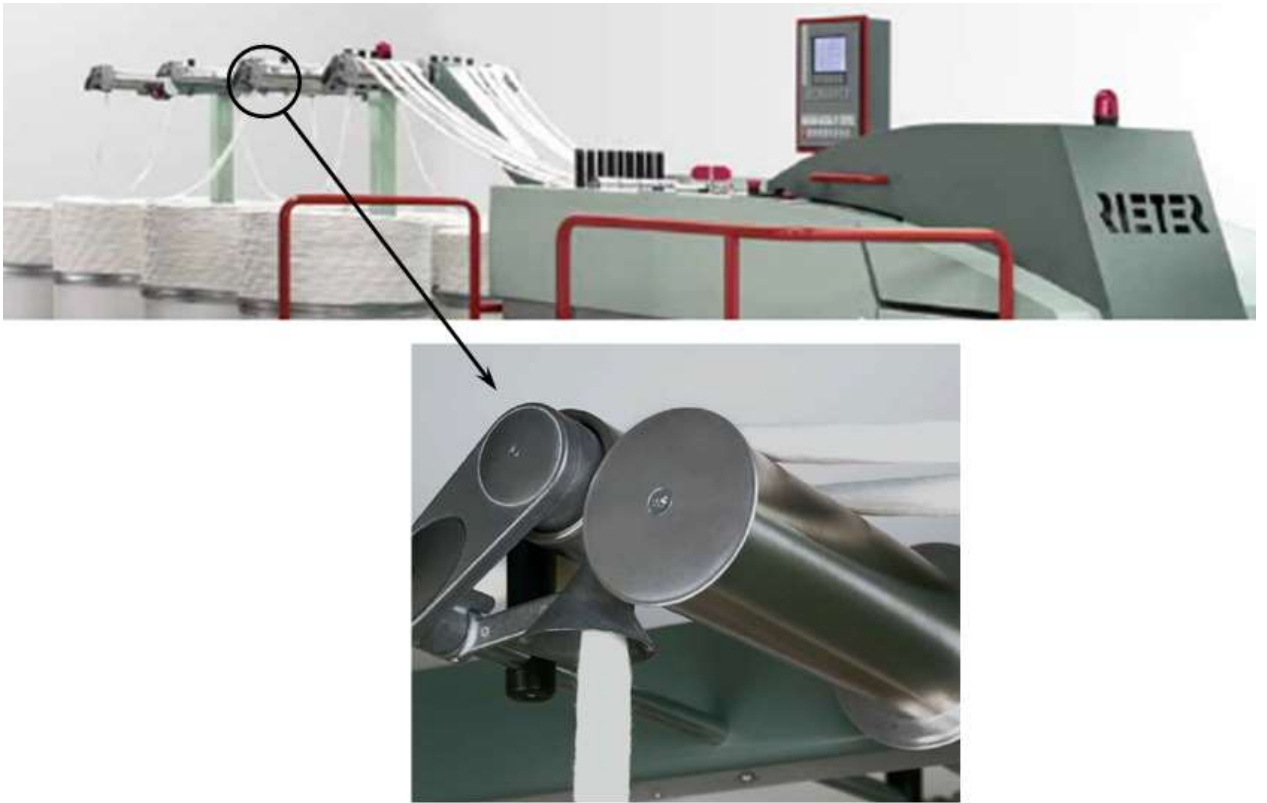
117 - расм. SB-D пилталаш машинаси таъминлаш қурилмасида пилта йўналтиргич
