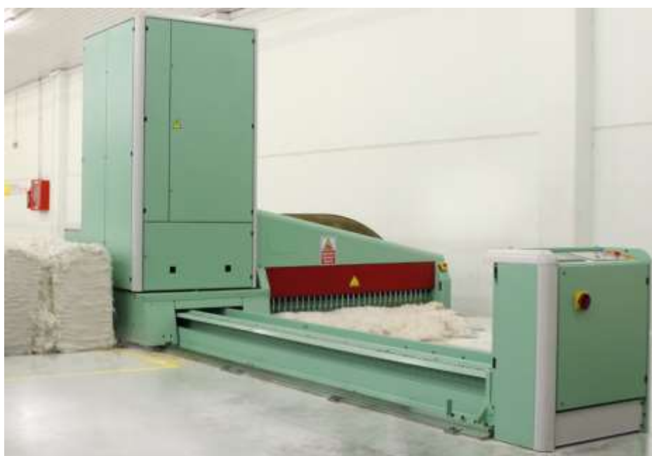
2 - расм. Blendomat BO-A (Truetzschler) автоматик той титиш машинаси: а) умумий кўриниши; б) ишлаши
