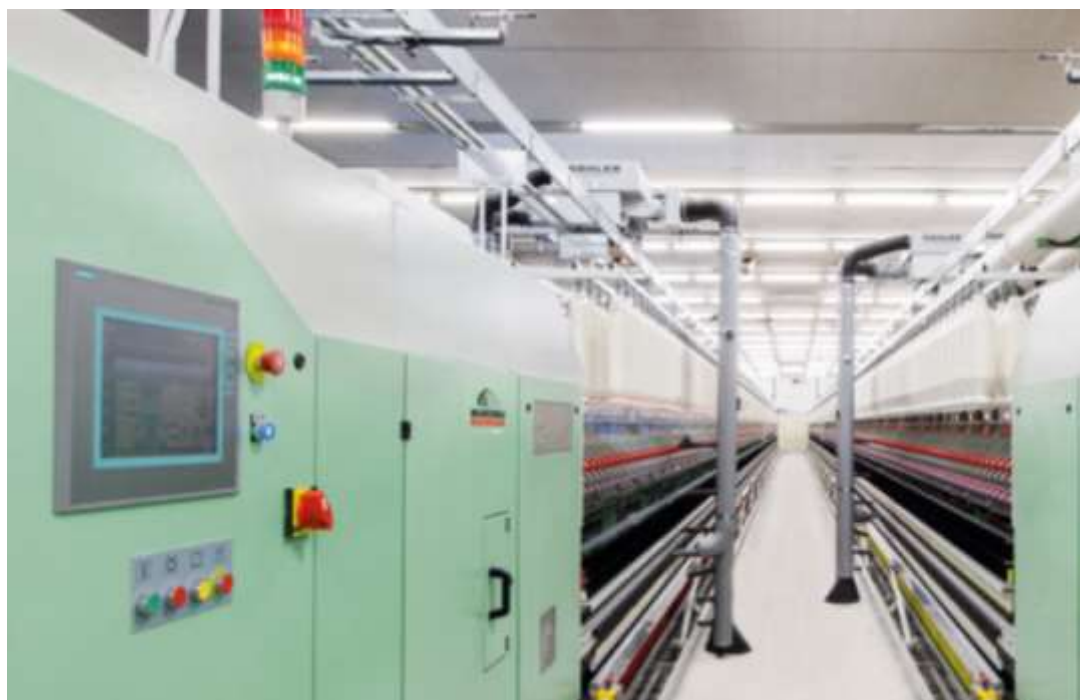
194-расм. Ҳалқали йигириш машинасида момиқ ва чангни тозалаш қурилмаси
