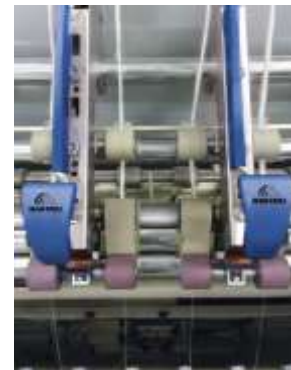
165 - расм. Марцоли фирмасининг 3x3 чўзиш асбоби
