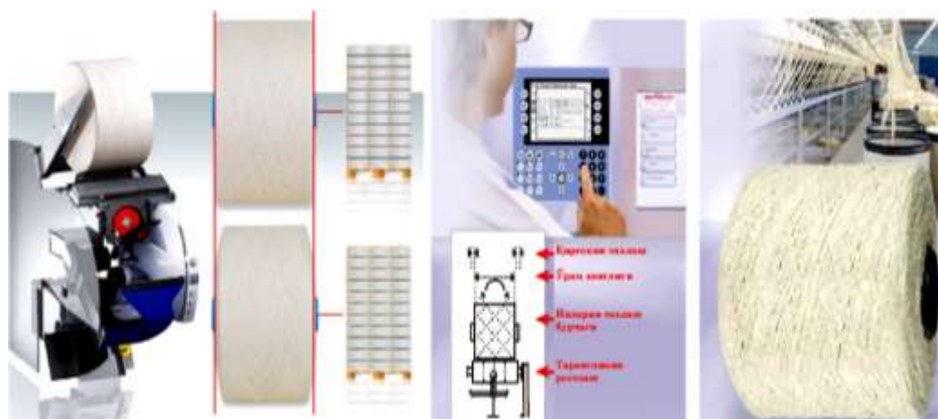
217-расм. Ипни ғалтакка ўрашнинг компьютерлашган автомат тизими
