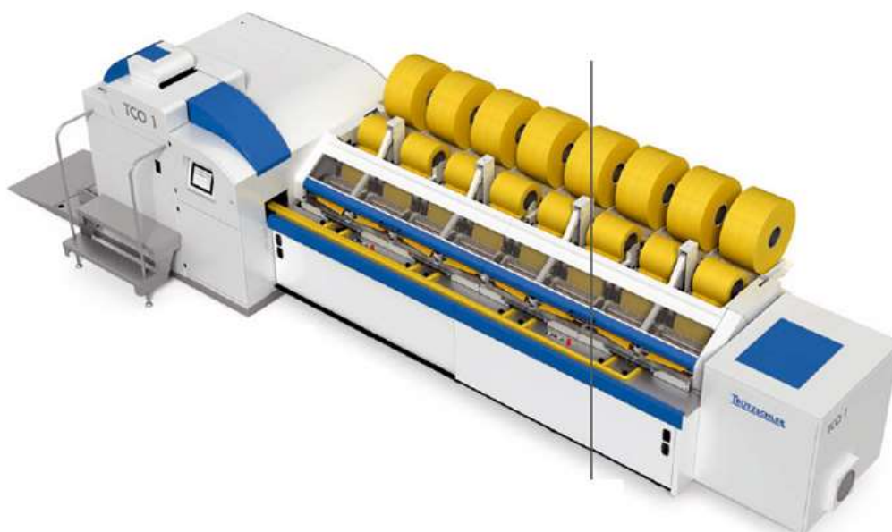
82 - расм. TCO-1 русумли «Truetzschler» фирмасининг қайта тараш машинаси
