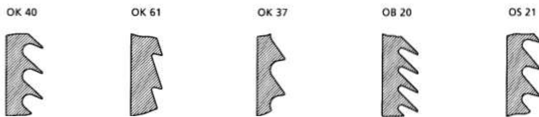
206-расм. Дискретловчи барабанча гарнитуралари
