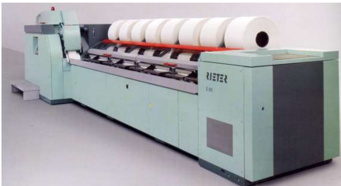
81 - расм. E 80 (Rieter) қайта тараш машинаси
