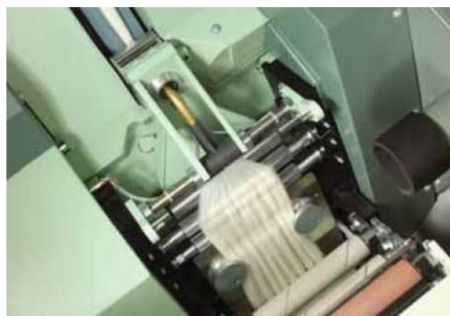
102 - расм. Қайта тараш машинаси 4x4 (Тручлер) (а) ва 3x3 (Ритер) (б) фирмалари чўзиш асбоби
