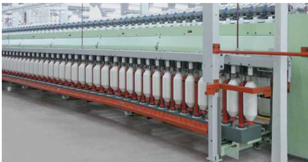
150 - расм. Пиликлаш машинасининг ғалтак кареткаси
