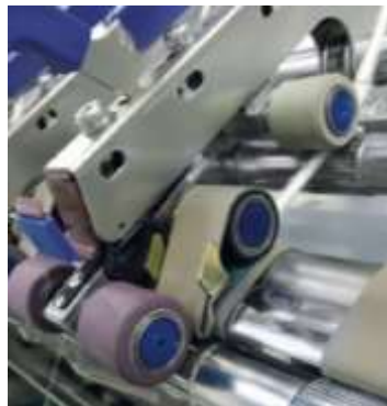
165 - расм. Марцоли фирмасининг 3x3 чўзиш асбоби
