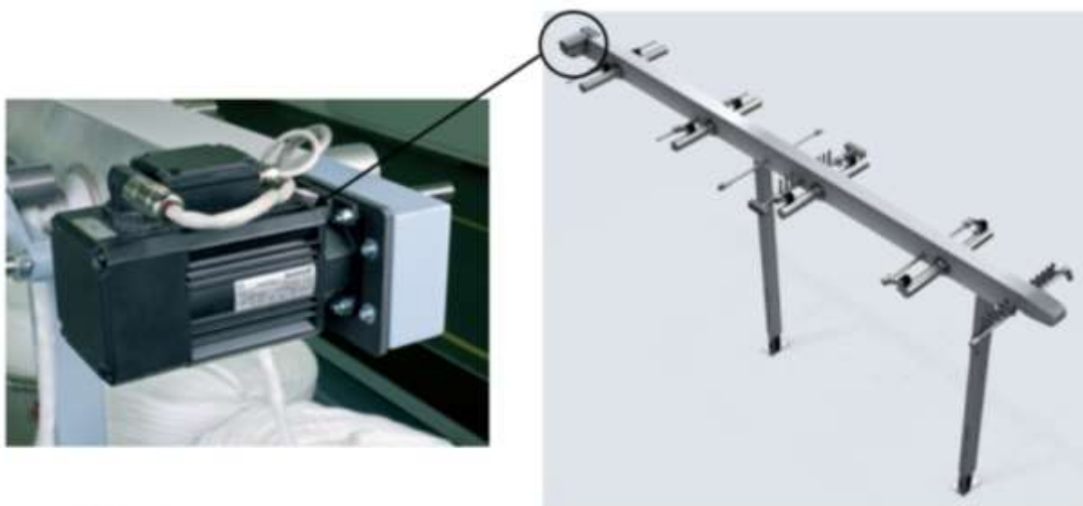
116 - расм. TD-07 пилталаш машинасининг серводвигателли таъминлаш қурилмаси
