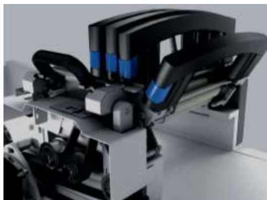
121 - расм. TD-07 пилталаш машинасининг 4x3 чўзиш асбоби
