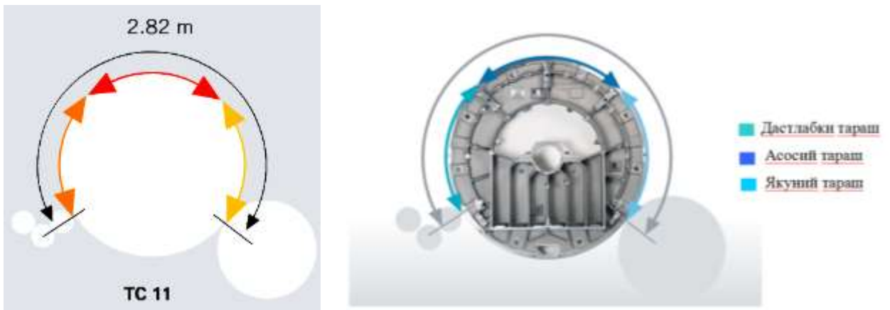
49 - расм. Асосий тараш зонасининг таркибий қисмлари
