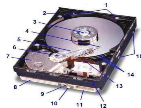
Рис. 3.28. Внутреннее устройство жесткого диска
