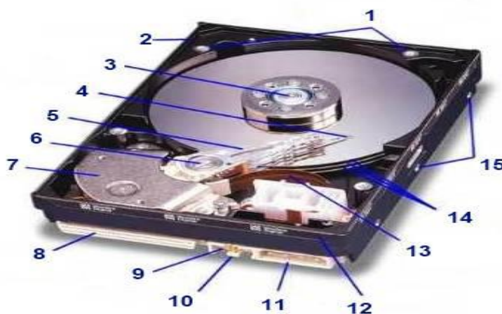
Рис. 3.28. Внутреннее устройство жесткого диска
