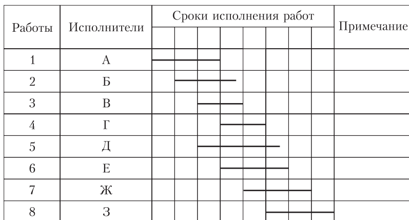
Рис. 7.3. Ленточный график контроля выполнения комплекса работ
